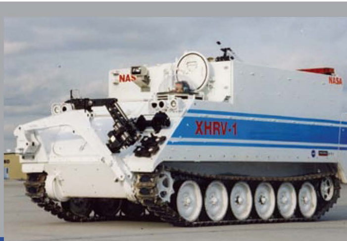
配有Grips机械臂的美国宇航局危险物料车协助应急人员处理化学、生物或放射性威胁。
